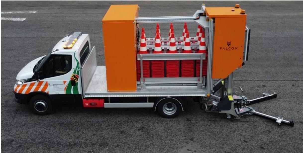
Abb. 1: Falcon 75 LKS auf einem Iveco Daily 70 chassis
