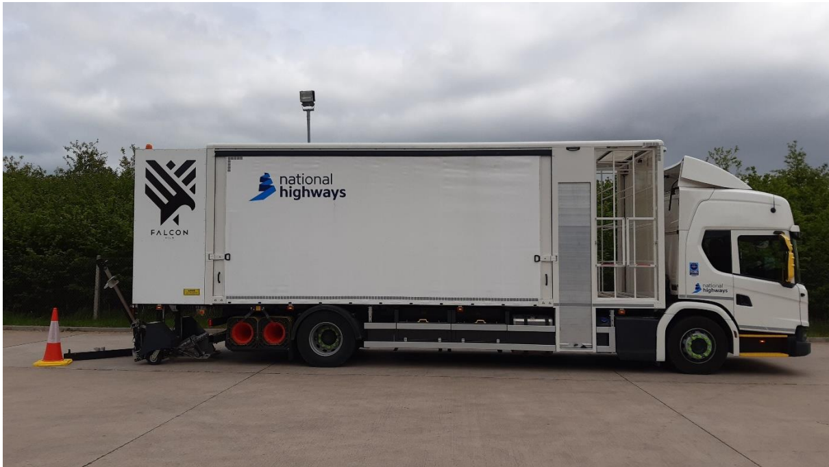
Abb. 1: Falcon 100 auf einem Scania L Serie Chassis
